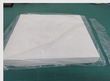
密封タイプにてシュリンク シール機にて溶断しています
